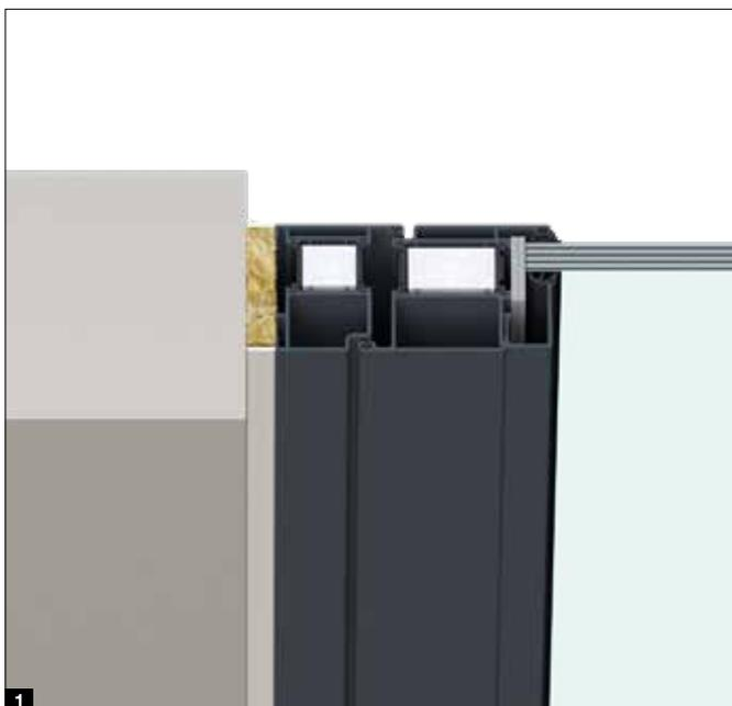
**CONSTRUCTION STANDARD.** Le cadre d'habillage **1** est utilisé pour les portes, les parties latérales, les impostes vitrées et les éléments vitrés. Vos avantages : d'une part, un montage simple et affleurant au mur et, d'autre part, une pose aisée de nombreuses combinaisons d'équipements et de composants de ferrures.
